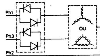
Placé au primaire d'un transformateur, le Gradipak supprime la pointe de courant magnétisant.
