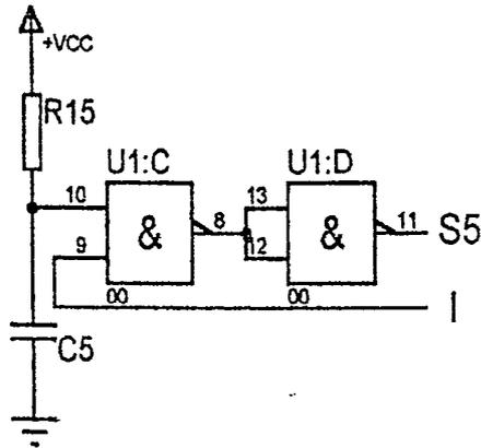
a - Calculer le temps de charge complet ( $t_{cc}$ ) du condensateur C5 et sa constante de charge ( $\theta_c$ ).
