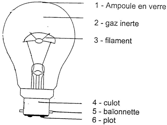
1.2 Expliquer le principe de fonctionnement d'une lampe à incandescence :
