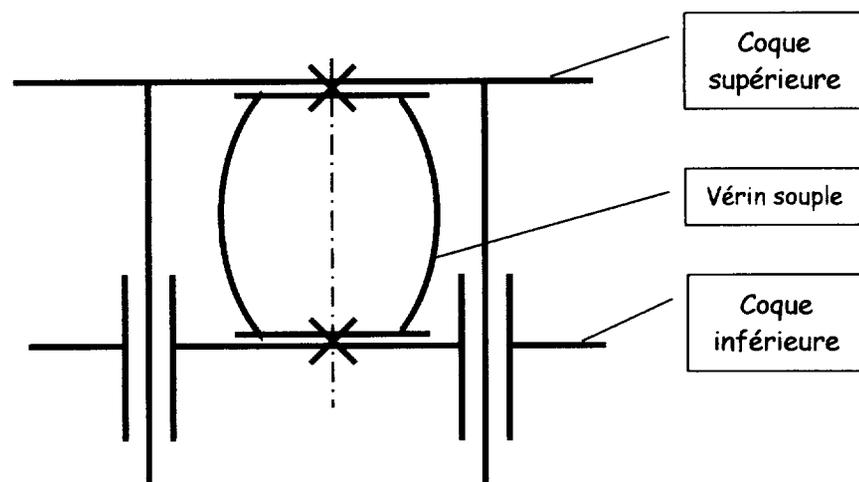
La nouvelle solution adoptée entraîne des modifications des pièces « Coque inférieure » et « Coque supérieure » du système existant. La conception de ces pièces d'accroche du vérin doivent respecter le cahier des charges suivants :
