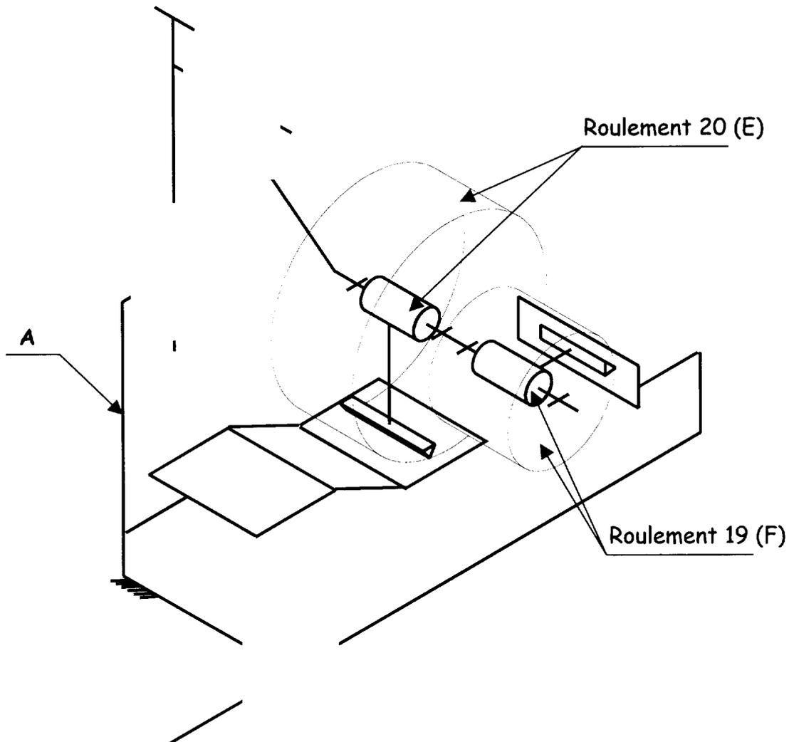
**1.2.4]** Déterminer graphiquement la position haute  $A'$  du point  $A$  (centre de liaison entre le levier et la coque supérieure). Celle-ci correspond à la mise en butée de l'amortisseur sur le corps du vérin.
