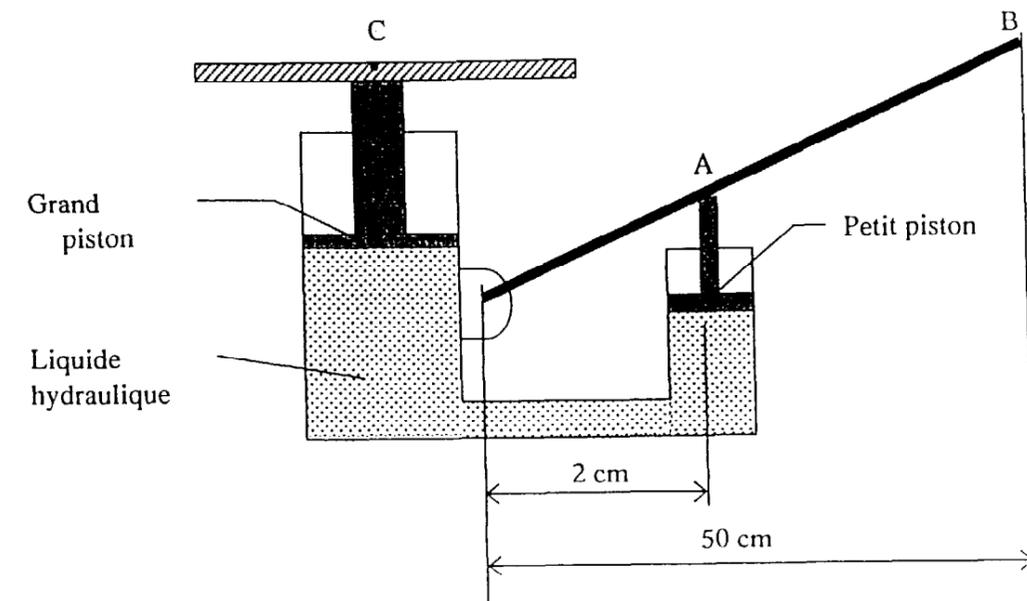
Les sections du petit piston et du grand piston sont respectivement de  $1 \text{ cm}^2$  et de  $20 \text{ cm}^2$ .
