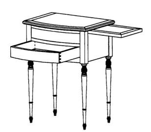
Hauteur: 740 mm Largeur: 550 mm Profondeur: 400 mm
