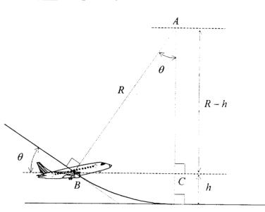
Le but de l'étude mathématique est de vérifier si les conditions de vol dans la phase d'atterrissage étaient conformes aux spécifications qui précisent que le facteur de charge  $\eta = 1 + \frac{V^2}{R g}$  ne doit pas être supérieur à 1,2.
