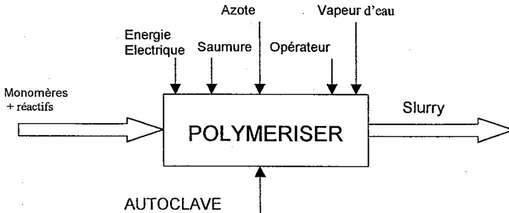
L'autoclave est une cuve sphérique de 8 m<sup>3</sup> dont la surface interne est en acier inoxydable. La pression avoisine 140 bar et la température est comprise entre - 40°C et +184°C. Il comprend un agitateur, des rampes d'injection et de vidange des produits, ainsi qu'un échangeur permettant soit d'apporter les calories nécessaires à l'initialisation de la réaction de polymérisation, soit d'évacuer les calories dégagées par la réaction elle-même.
