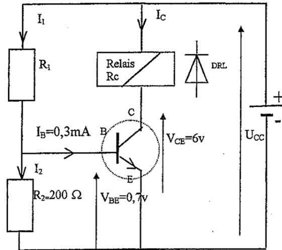
Le transistor possède un coefficient d'amplification  $\beta = 100$ .
