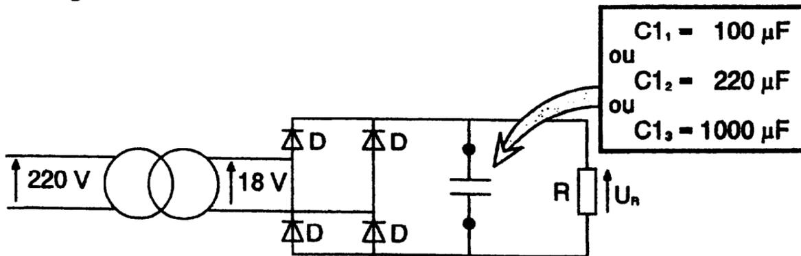
Le condensateur C1 est détérioré, il faut le remplacer.
