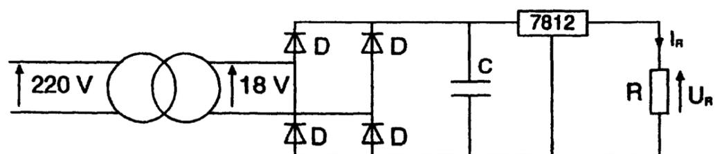
Faire un essai en mesurant le courant  $I_R$ , afin de mettre en évidence le comportement du régulateur (sans dissipateur).
