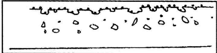
➤ Un dépôt chimique de nickel (environ 1µm) va pouvoir être réalisé sur la surface, rendant cette dernière conductrice. On dépose alors 30µm de cuivre puis 15µm de nickel. Un flash de bronze peut ensuite être déposé sur la plaque porte attribut.
