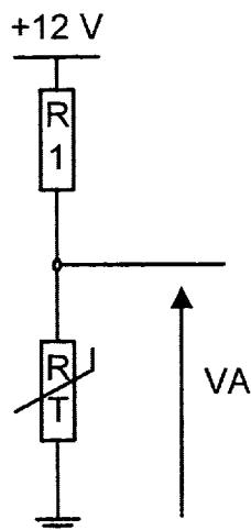
**La thermistance NTC1 a une valeur ohmique RT de 10 K Ohms à 25°C**
