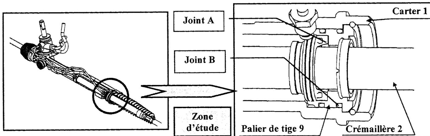
A l'aide du *Dossier ressource* ( document 10/10 ) et des informations ci-dessous, compléter le tableau ci-après permettant l'analyse des joints d'étanchéité A et B.
