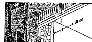
7. DISTANCE SUSPENTE/PAROI VERTICALE Cas où l'ossature est perpendiculaire à la paroi verticale.
