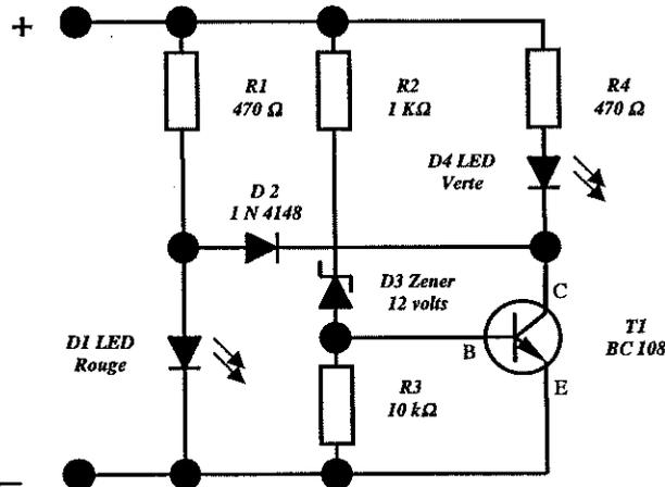
2 – Dans le circuit électronique ci-dessus, vous réalisez le montage de la LED D4 Verte avec la résistance R4. Sachant que la tension aux bornes du montage est de 12 volts, vérifiez par le calcul et d'après le tableau joint la valeur de la résistance R4 ? / 8
