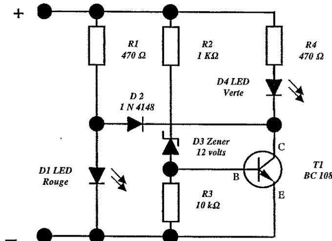
5 – En analysant le fonctionnement du montage, expliquez brièvement la fonction de la diode **D2** ? / 4
