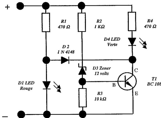
3 – Dans le circuit électronique ci-dessus, vous réalisez le montage de la Led D1 Rouge avec la résistance R1. Sachant que la tension aux bornes du montage est de 12 volts, vérifiez par le calcul et d'après le tableau joint la valeur de la résistance R1 ? /7
