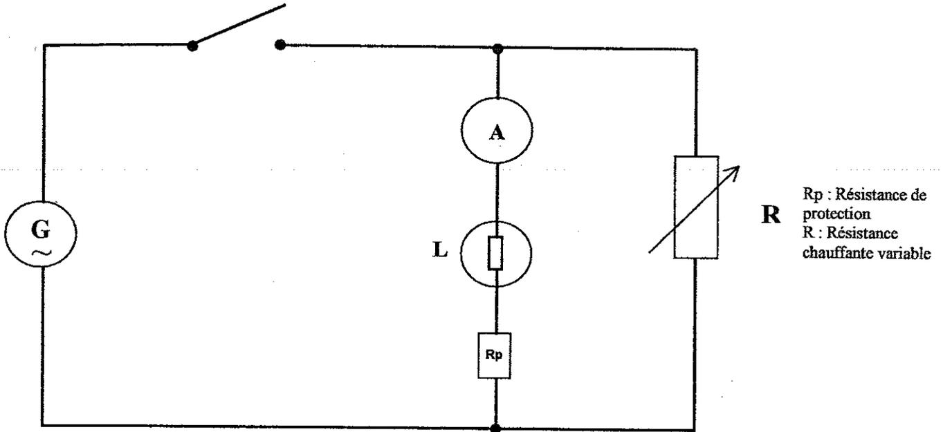
4.1. Compléter le schéma du circuit électrique en plaçant l'appareil qui permet de mesurer la tension aux bornes de la lampe L.
