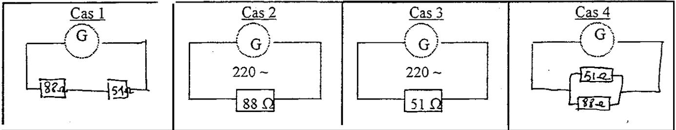
2 - Calculer la résistance-équivalente dans le cas du montage 1 (en série)
