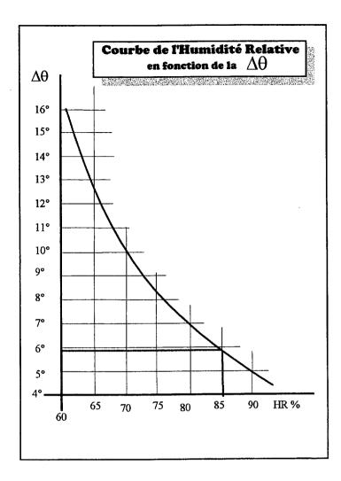
A/ Effectuer sur ce diagramme le tracé vous permettant de connaître la  $\Delta\theta$ permettant d'obtenir l'humidité relative dans la chambre positive, demandée dans le cahier des charges (HR=85%)
