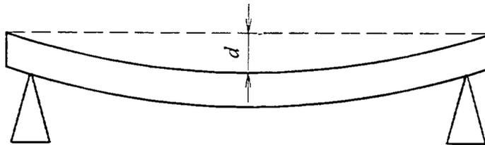
Pour le type de matériau utilisé, la flèche  $d$ , en mètres, est donnée par la relation :
