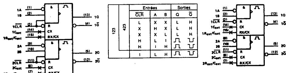
Boîtier DIL 16 -  $V_{CC}$  16 - GND 7
