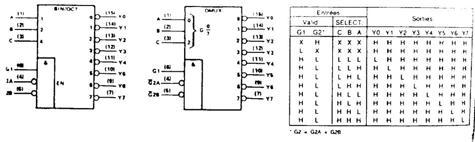
Boîtier DIL 16 -  $V_{CC}$  16 - GND 8
